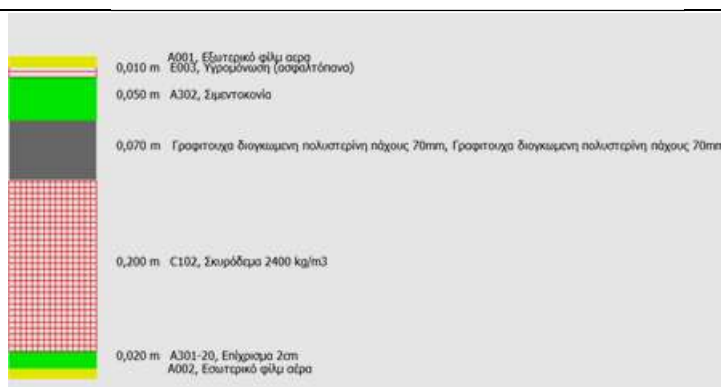
Εικόνα 8: Τομή οροφής με εφαρμογή της προτεινόμενης θερμομόνωσης.
